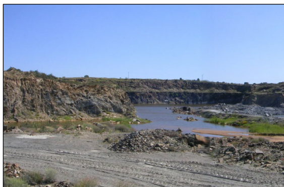
Figura 4. Cantera de áridos en las grauvacas del Culm de la zona Surportuguesa, en los alrededores de Gibraleón. Fotografía de C. Feixas.
