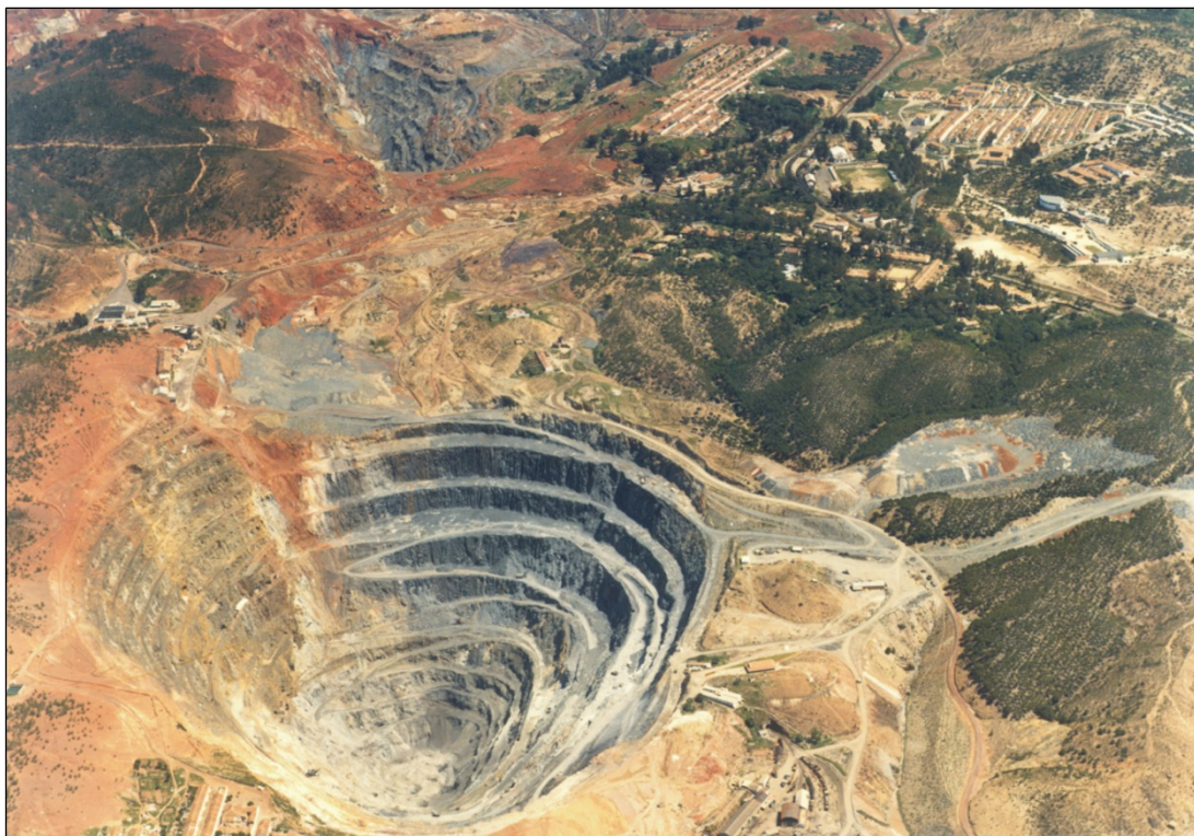
Figura 2. Vista aérea de parte de las explotaciones de Riotinto en 1964. En primer término Corta Atalaya, una de las grandes cortas que comenzaron a desarrollarse a final del siglo XIX, al igual que la corta de Filón Sur, en la parte superior de la foto. El denominado Cerro Colorado, que puede verse en la esquina superior izquierda y que se identifica por el color rojizo de los óxidos de hierro, constituía el mayor afloramiento de gossan de la Faja Pirítica. En la fecha de la foto todavía no había comenzado su explotación, que se dio por finalizada en 2002 (comparar con figura 3). Foto cedida por el Archivo de la Fundación Minas de Riotinto.
