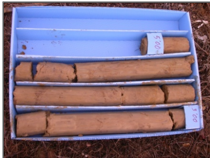
Figura 4. Ensayo de penetrómetro con sondeo realizado para la construcción de la Guardería Infantil de la Universidad de Huelva en el Campus de "El Carmen", donde aflora la Fm. Arcillas de Gibraleón. Abajo se muestra el testigo de los materiales obtenidos.
