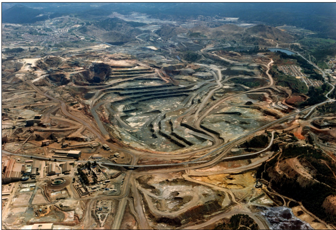
Figura 3. Vista aérea actual de la corta de Cerro Colorado y de parte de las instalaciones de las minas de Riotinto. En la imagen se observa como el Cerro Colorado (ver figura 2), está totalmente explotado, y unidas las antiguas cortas de Filón Sur y Filón Norte, constituyendo una de las mayores, si no la mayor explotación a cielo abierto de la provincia de Huelva. En ella, además del gossan para obtención de Au y Ag, se explotó extensamente la mineralización de "stockwork" para Cu, de la que todavía existen importantes reservas. Foto cedida por E. Romero.
