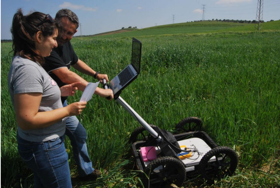
Imagen 4.4.18 Ejecutando las pasadas (perfiles) con el georradar.
