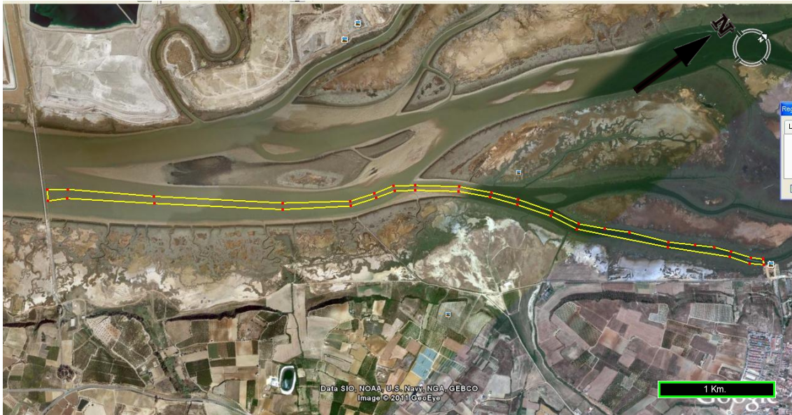
Imagen 5.18 Encauzamiento del canal de tráfico de acceso al puerto. Google Earth y Autor.
