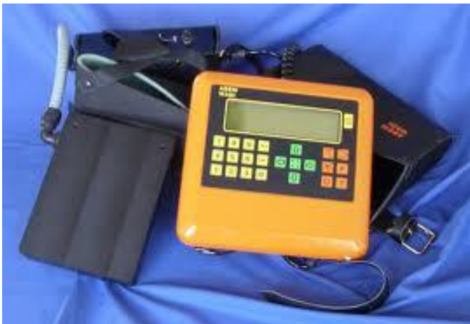
Imagen 4.4 15 Sistema de prospección WADI empleado.
