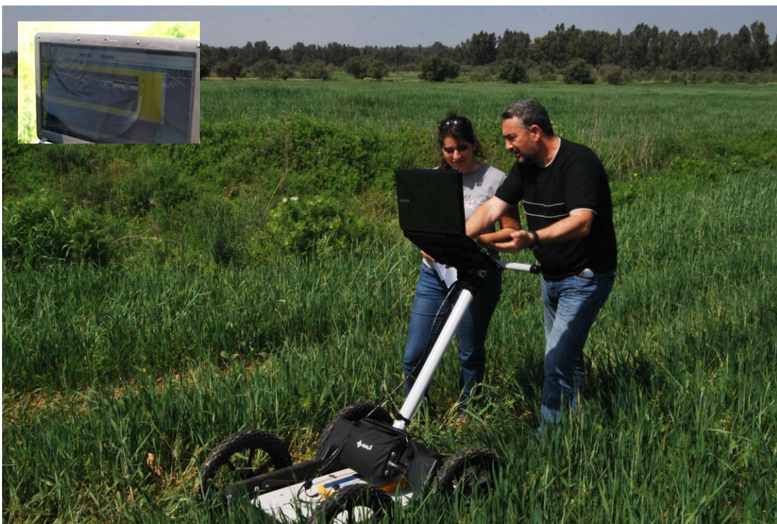
Imagen 4.4.14 Pasadas equidistantes cada 5 metros. Arriba. Visualización en pantalla.
