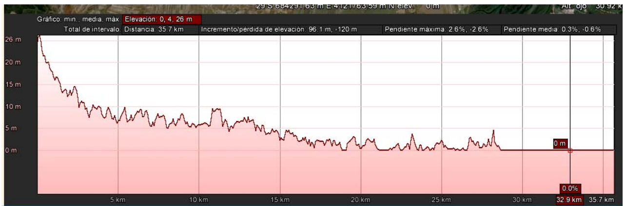
Figura 2. 18 Perfil longitudinal con indicación de los parámetros altimétricos del eje del río cerca de unión con el río Odiel. Factor de escala vertical = 200
