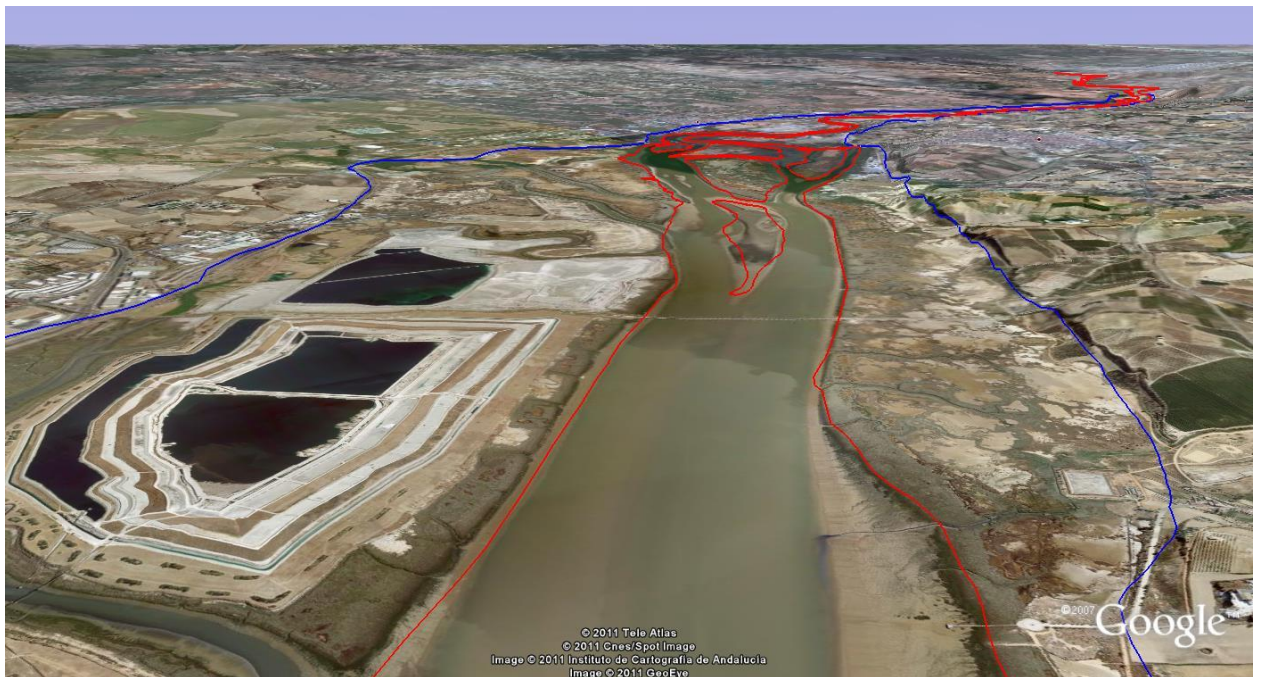
Imagen 2.17 Huellas de las orillas en el pasado (Líneas azules). Imagen que simula una fotografía aérea de eje inclinado. Google Earth
