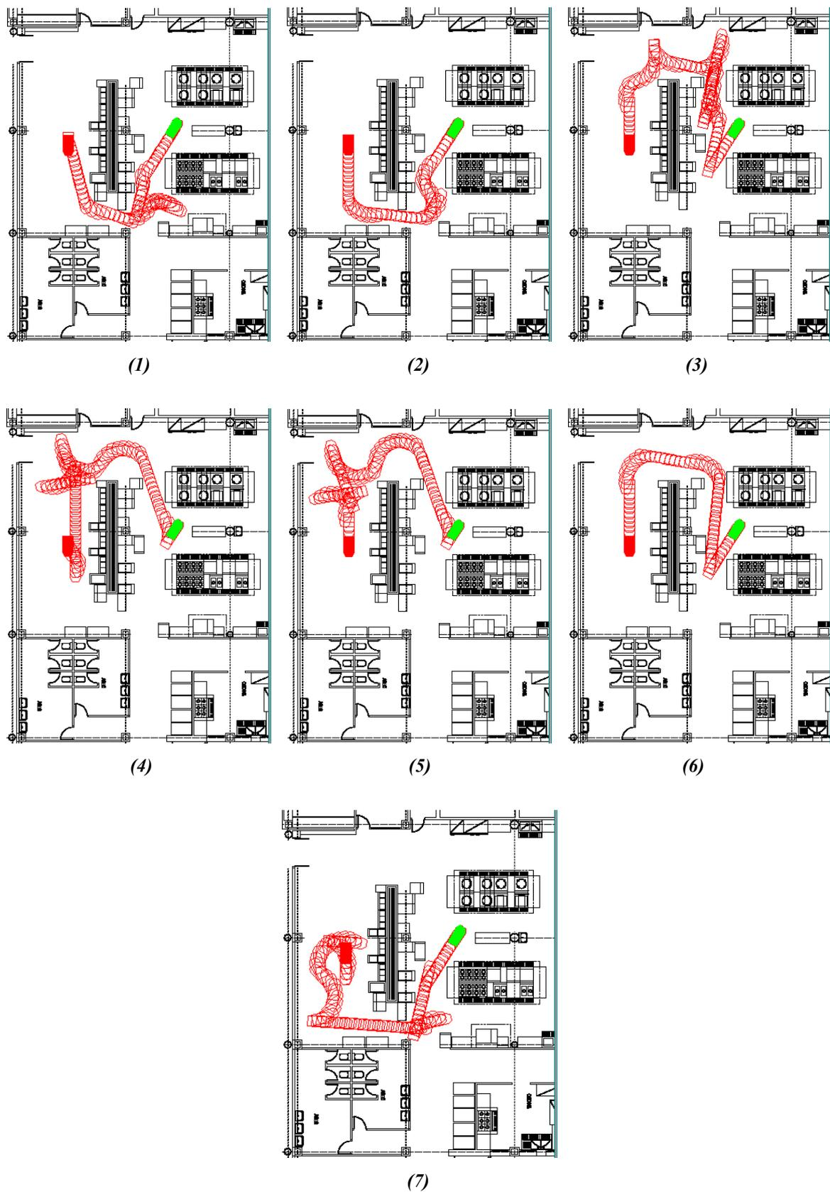
Figura 6.10: Diferentes trayectorias para las mismas configuraciones inicial y final.
