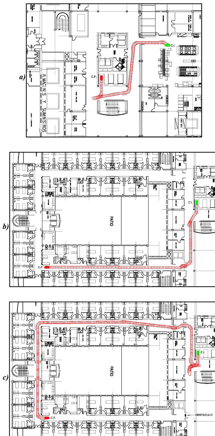
*Figura 6.7: Trayectorias planificadas para el traslado del menú: a) salida del almacén hasta los ascensores; b) camino desde los ascensores hasta el punto de reparto; c) ruta alternativa por oclusión de la ruta principal.*
