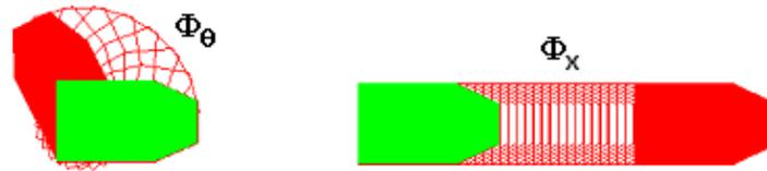
Figura 4.4: Maniobras restringidas en el robot diferencial
