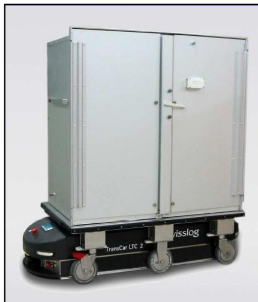
*Figura 6.6: Plataforma autónoma para la automatización de reparto en entornos hospitalarios.*
