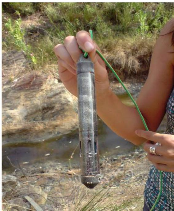
**Figura VI.39.** Fotografía de los precipitados sobre el data-logger.
