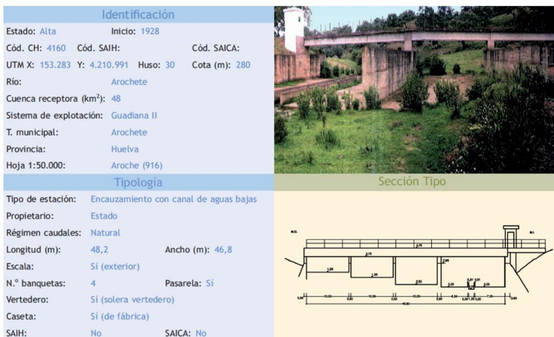
Figura II.8. Ficha técnica de la estación de aforo 4160 en el río Arochete.
