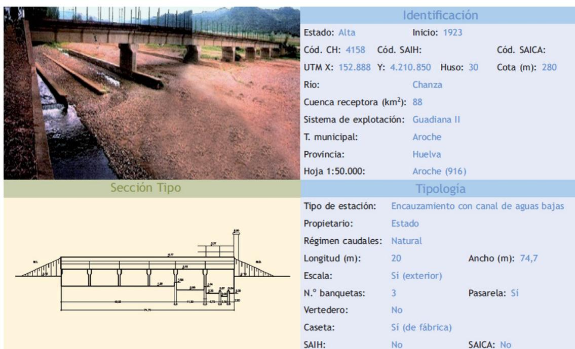
**Figura II.7.** Ficha técnica de la estación de aforo 4158 en el río Chanza.
