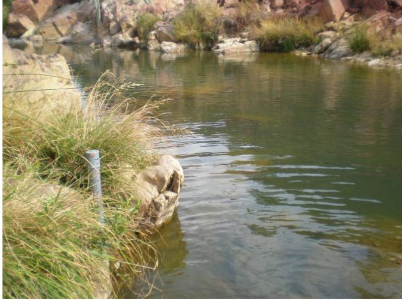
**Figura VI.21.** Fotografía de detalle de la instalación del data-logger en la rivera del Olivargas.
