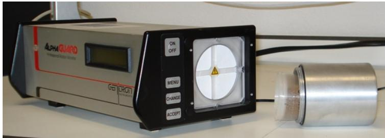
Figura 3.5 Cámara de acumulación basada em detector AlphaGUARD.  $V_c=590 \text{ cm}^3$ ,  $V_m=124 \text{ cm}^3$ ,  $S=21.3 \text{ cm}^2$ . A la derecha se observa la pieza roscada de Al con la muestra en su interior.
