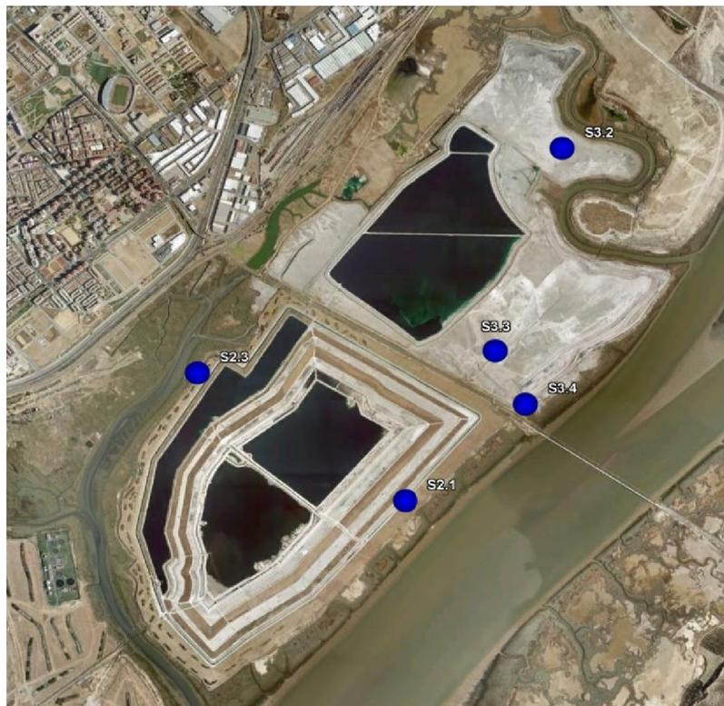
Figura 3.4 Localización de los sondeos geotécnicos realizados en 2009
