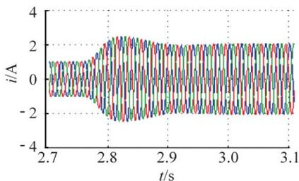
图10 接口换流器交流侧电流波形
