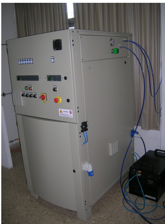
Figura 5.11: Electrolizador alcalino de 0,5 Nm 3 /h
