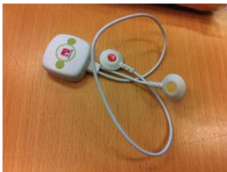
Figur 6-4, Billede 4: HRV-måleudstyret er fra det finske firma Mega Electronics ( http://www.megaemg.com/products/emotion-hrv/ ). Elektroderne, der påsættes huden under højre kraveben samt på venstre side af brystkassen, kan klikkes på i de to ender, og udstyret hænger således næsten vægtløst på testdeltagerens bryst, der bærer måleren døgnet rundt.
