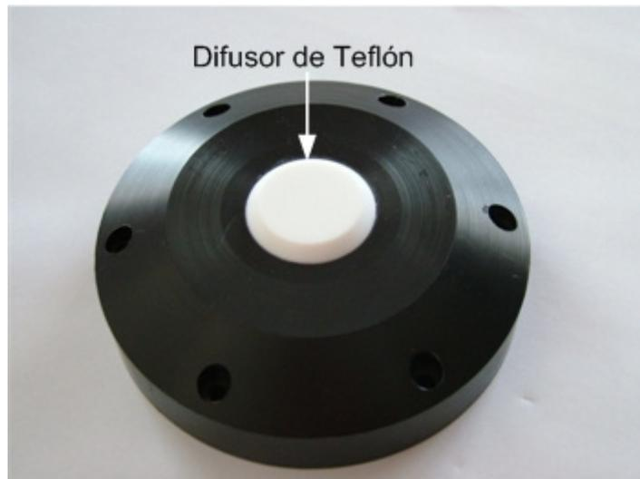
Fig.4.3. Detalle del difusor de teflón alojado en la tapa del piranómetro
