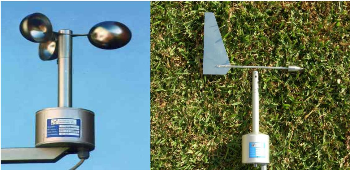
Fig. 6.2. Anemómetro (izda.) y veleta (derecha) utilizados.
