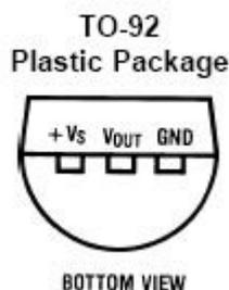
Fig. 4.21. Encapsulado y patillaje del sensor de temperatura LM35
