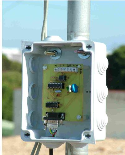
Fig. 6.3. Módulo de adquisición y acondicionamiento de las señales del anemómetro y de la veleta.
