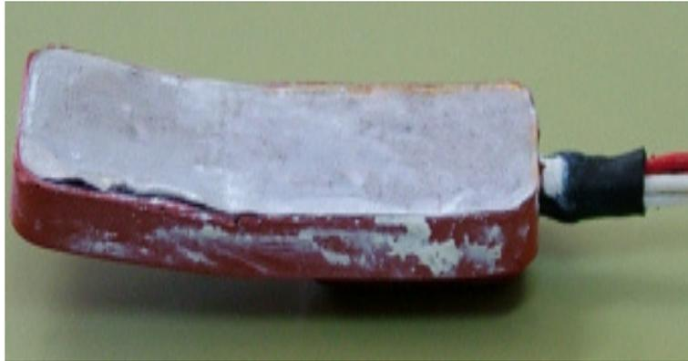
Fig.3.18. Pt100 adhesiva, para la colocación en paneles solares.
