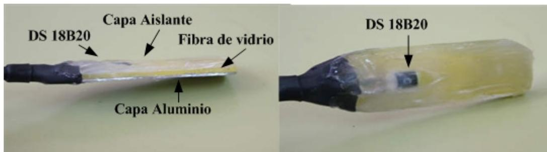
Fig. 3.11. Sensor encapsulado para poder ser utilizado en el exterior.
