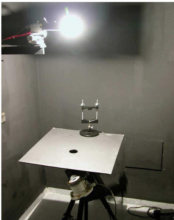
Fig. 5.12. Fotografía de un radiómetro bajo test en la Esat.
