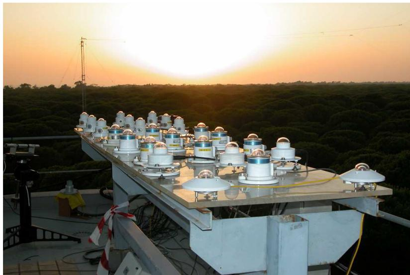
Fig. 5.14. Radiómetros colocados en la terraza de la estación en el INTA.
