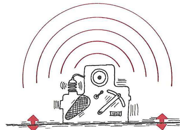
Figur 2. Maskinen frembringer vibrationer i gulvet. Disse sætter luften i bevægelse, og der opstår lyd.
