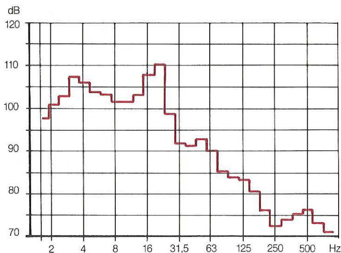
Figur 7. Frekvensanalyse af støj i en almindelig personbil. En forrude er åben, og farten er 110 km i timen.
