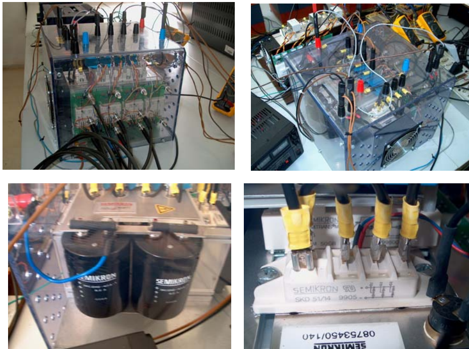
Figura A1.8 Inversor de potencia trifásico de Semikron, detalles.
