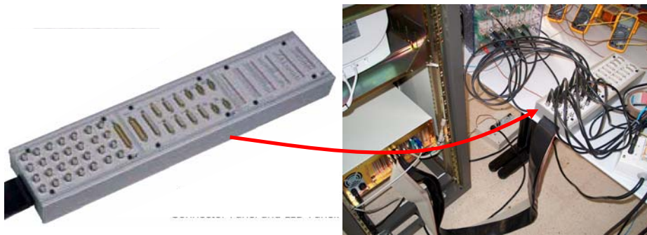
Figura A1.6 Interface I/O entre el sistema de potencia y el PC, y detalle de su instalación.
