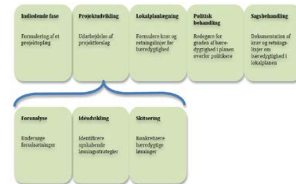
Figur 5: Planlægningsfaser i projektudviklingen i en typisk planlægningsproces (øverst), og en strategisk proces, hvor projektudviklingen indeholder flere delprocesser (nederst).
