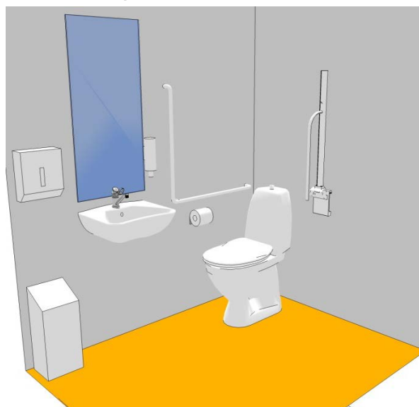
Figur 1: Eksempel på indretning efter MSC Circ. 735. Vendeplads for kørestolsbrugere bliver i dette tilfælde for lille. Ved denne model anbefales fastmonteret armstøtte som vist på figuren.
