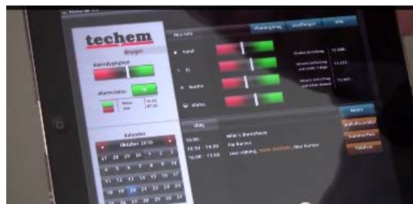
Figur 15. I flere private udlejningsejendomme rundt om i landet gøres der nu forsøg på via skærme at påvirke beboerne til at skrue ned for forbruget. Her opgangsskærme i ejendommen Wilkenbo på Frederiksberg.
