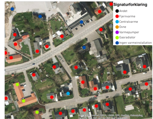
Figur 39. Eksempel fra varmeatlas på varmeinstallationer i bygninger.
