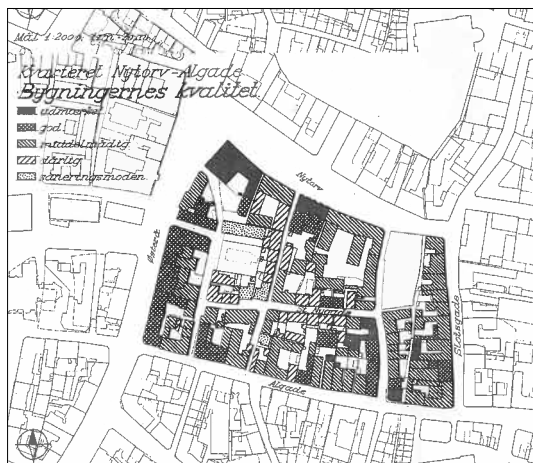
Registrering af bygningernes kvalitet i kvarteret mellem Nytorv og Algade som senere blev saneret og i stedet fyldt op med stormagasinet Salling. Fra forarbejde til dispositionsplan, 1948
