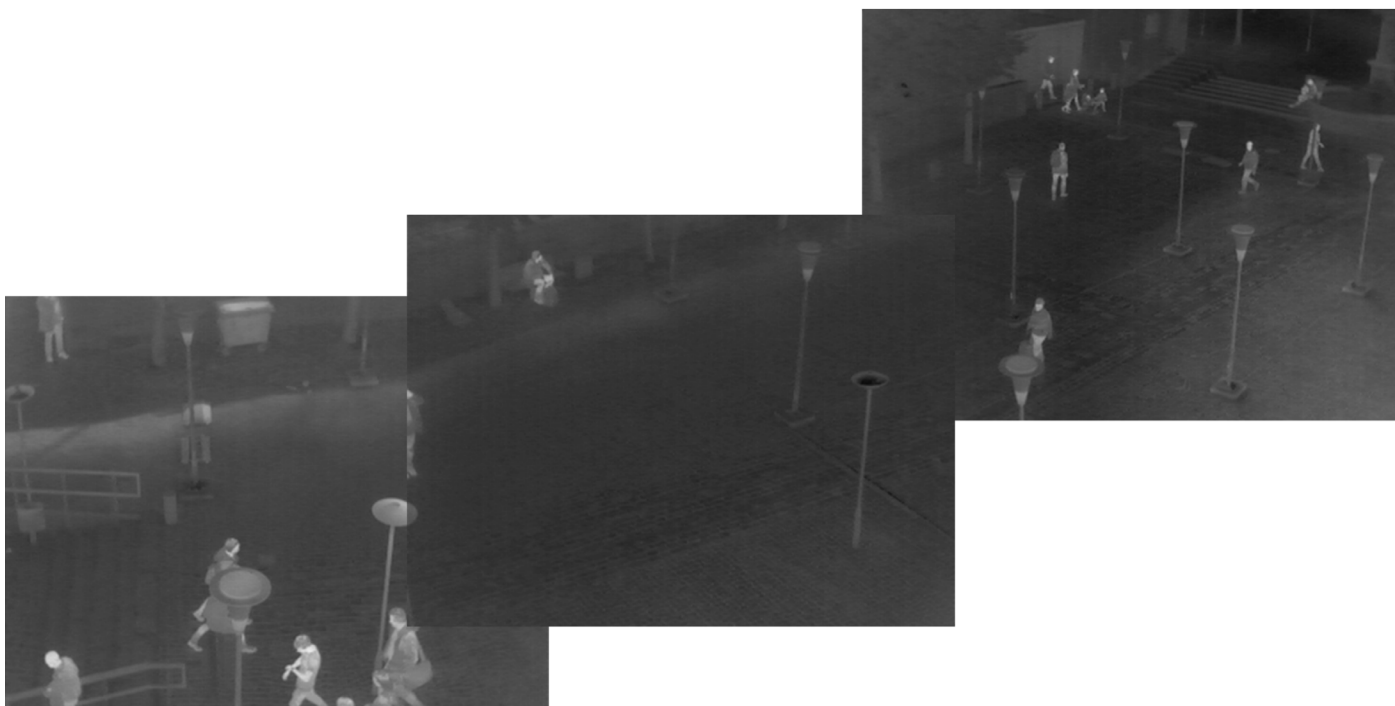
Figur 1. Billeder fra tre termografikameraer placeret i 12 meters højde på Gl. Torv i Aalborg.
