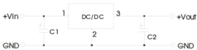
Figura 5.6. Aplicación típica de la fuente conmutada LM78_09-2.0R. [19]
