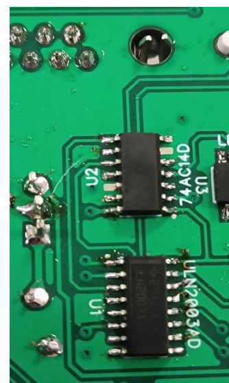
Figura 6.1. Detalle del chip 74AC14D sin los pines 6 y 12.
