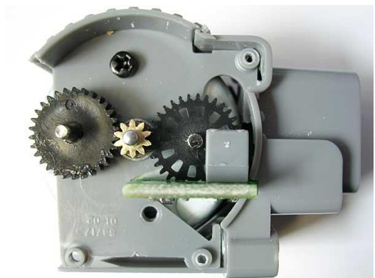
Figura 2.15. Detalle del encóder del motor NXT. [6]
