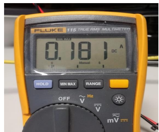
Figura 5.5. Intensidad nominal del motor NXT.
