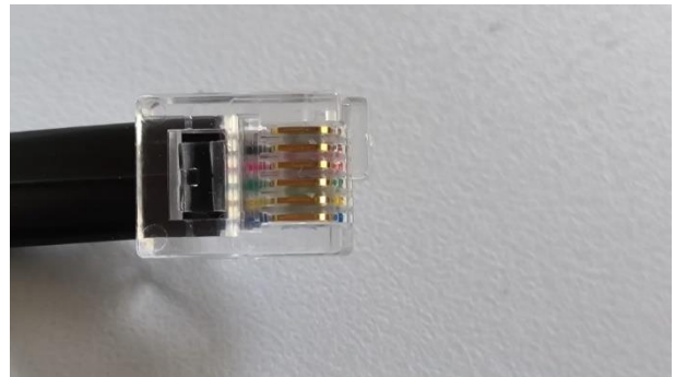
Figura 2.17. Detalle del conector del motor NXT.
