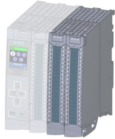
Figura 2.4. Posición del módulo de e/s analógicas en el autómata. [3]
