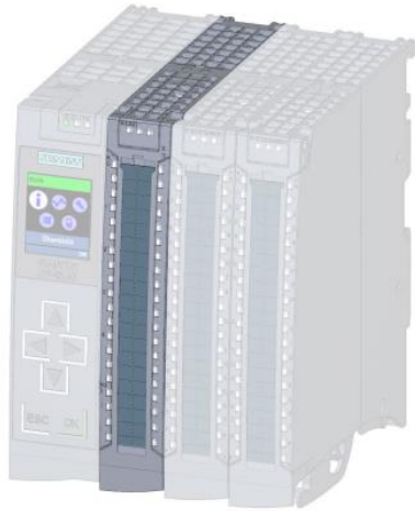
Figura 2.5. Posición del módulo de e/s analógicas en el autómata. [3]
