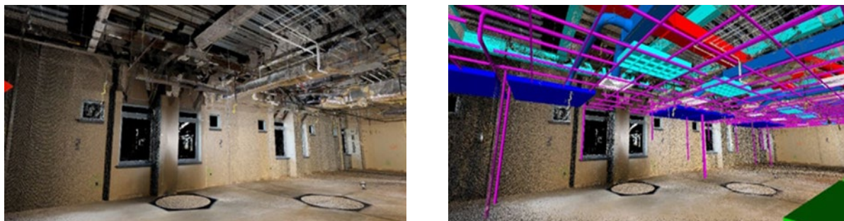
Slika 10: Prikaz oblaka točk, prepoznavanje in vključevanje modeliranih komponent.
