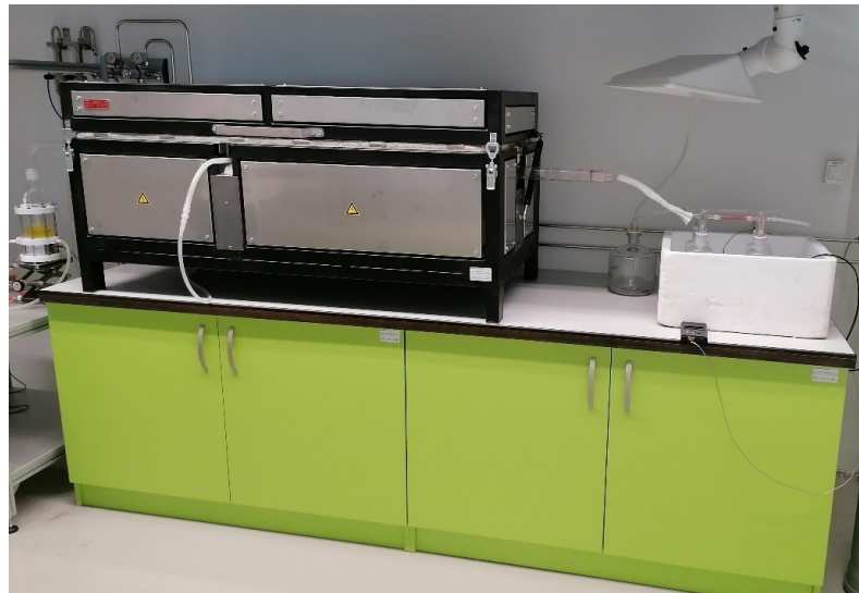
Slika 9: Modificirana USP naprava v Zlatarni Celje, d. o. o.
