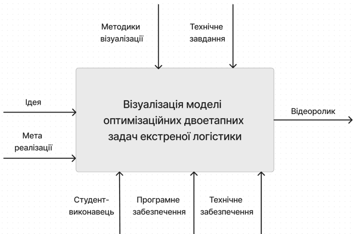
Рисунок 3.1– Діаграма нульового рівня (контексна) моделі IDEF0
