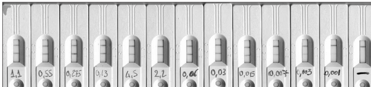
Figura 1. Determinazione della sensibilità analitica del metodo cromatografico mediante sospensione calibrata a scalare (da sinistra a destra) da 1.1 mg/ml a 0.001 mg/ml di H.pylori (ceppo CGUG 17874, cresciuto in terreno liquido). In posizione n.5 e 6 da sinistra) sono inseriti dispositivi caricati con sospensione batterica a maggiore concentrazione (4.5 mg/ml e 2.2 mg/ml, rispettivamente).
