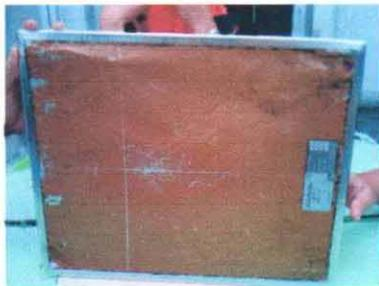
Gambar 5.1 Grid aluminium sebelum diganti dengan *carbon fiber*
