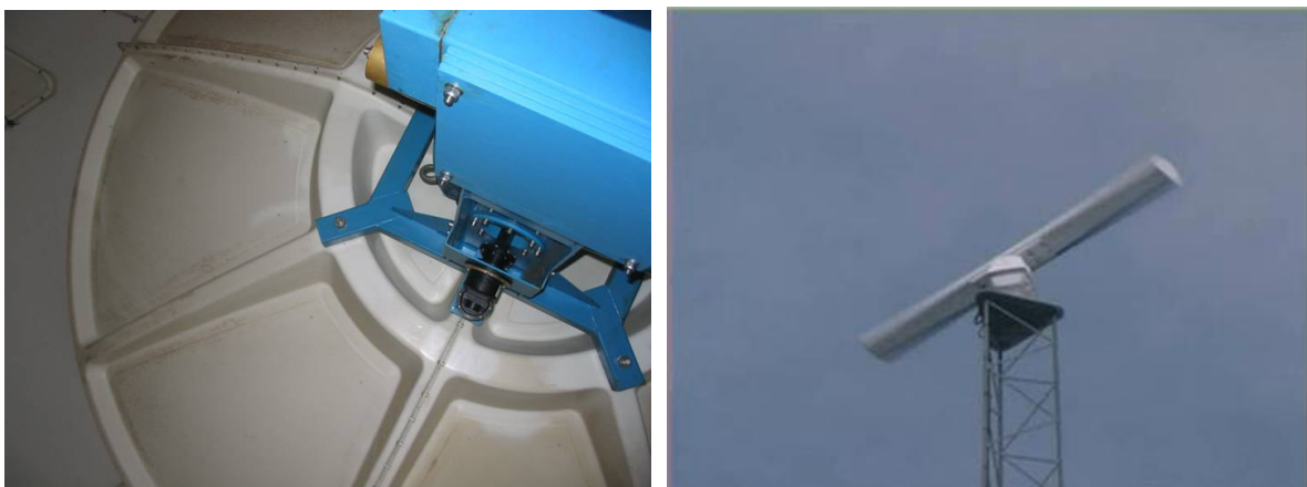
Figur 4.2.d Eksempel på C-båndsradar (Sindal) med parabol antenne og X-båndsradar (Aalborg) med slotted array antenne.
