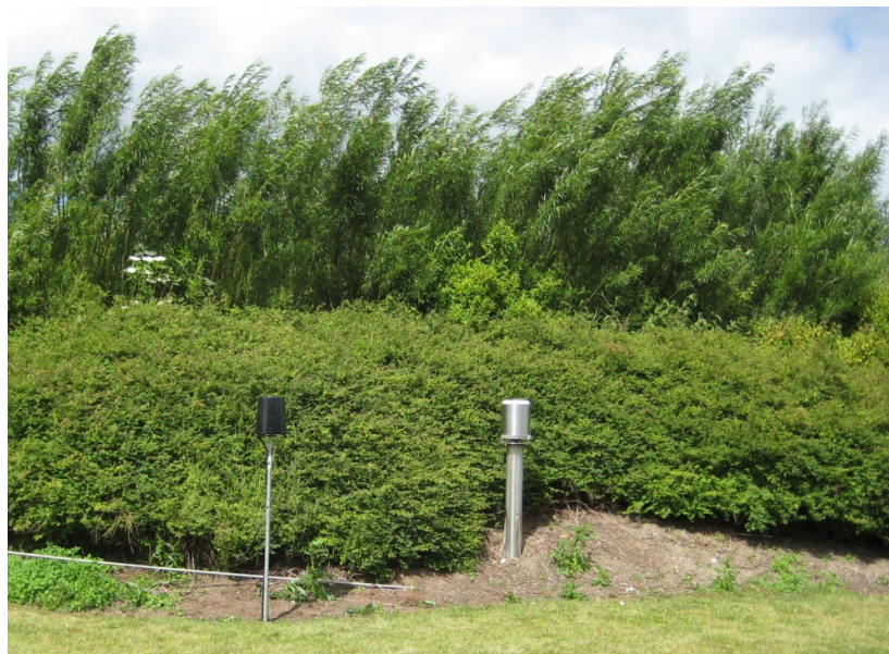
Figur 5.6.2.a AAU-regnmåler 28 opstillet ved siden af SVK-måler 26376 på Tønder centralrenseanlæg.
