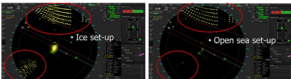
Kuva 3-5: Tutkanäyttö eri asetuksilla tuulivoima-alueiden läheisyydessä (Neste, M/T Lunni (Traficom & Väylävirasto, 2023))
