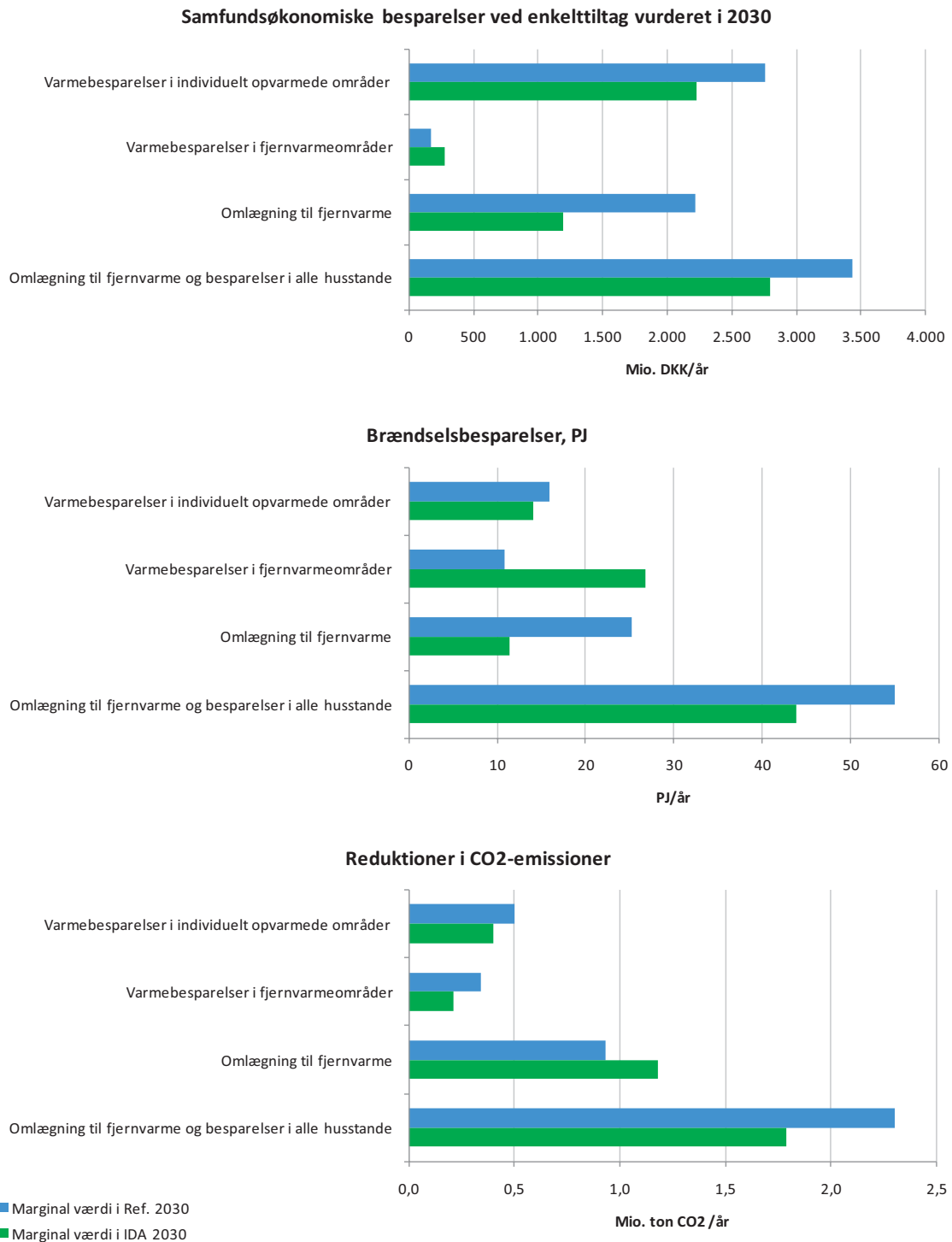
Figur 4-3 Analyse af varmebesparelser og fjernvarmeudvidelse
