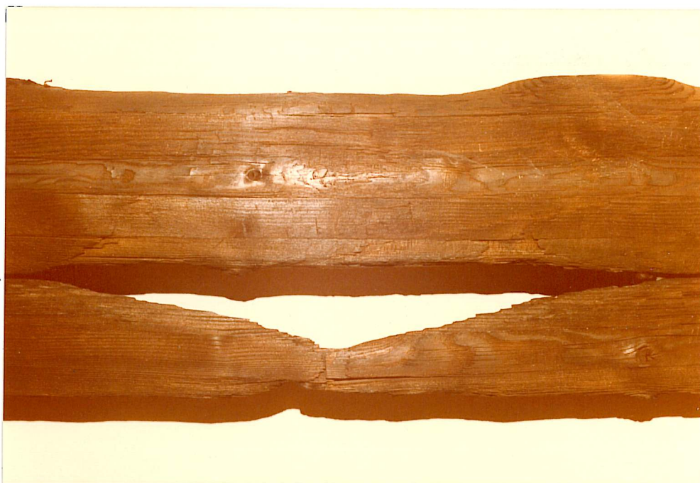
Figur 1. Limtræbjælke (tværsnit 140·300 mm) efter 90 minutters brandpåvirkning i h.t. ISO 834. Trækullaget er afbørstet. Efter 37 minutters brandpåvirkning svigtede fingerskarringen i den tredienederste lamel momentant, hvilket gav anledning til den stærkt accellererede indbrænding i de overliggende lameller.
