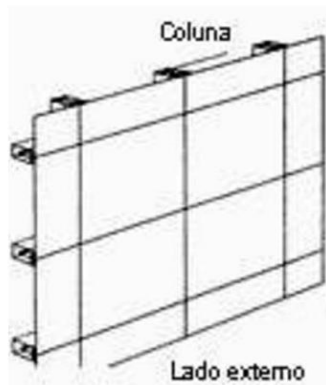
Figura 15. Fachada Structural Glazing Fonte: (PIEROZAN, 2016)
