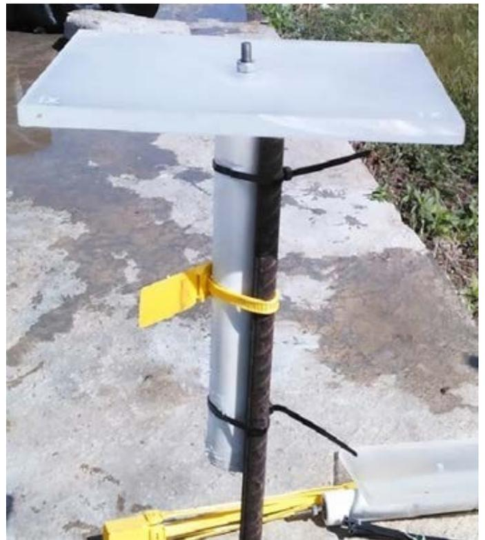
**Fig. 2.** Dispositivo de muestreo para estimación de la tasa de calcificación. Adaptado de Price *et al.*, (2012).
