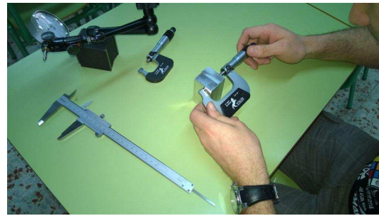
(b) Calibración del cuerpo que contendrá la cavidad según el estándar WR – 75.
