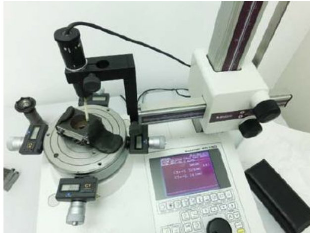
Figura D.8. Medición de la redondez con Mitutoyo RA-120.
