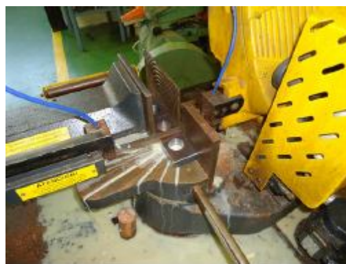
Figura 4.20. Corte de pieza sólida en tres piezas independientes.
