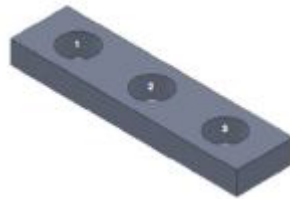
Figura 4.17. Pieza de acero F1115. (Con un diámetro de 21 mm).
