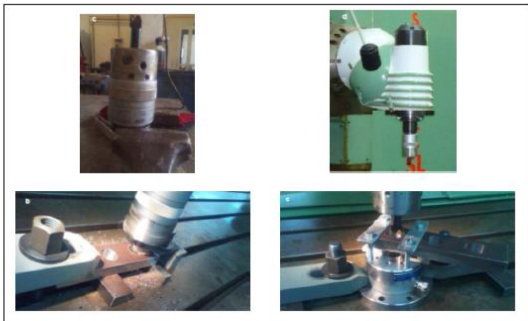
Figura C.2. Taladrado y roscado de agujeros.
