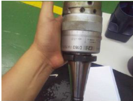
Figura C.8. Cabezal de mandrinar utilizado en todas las operaciones de mandrinado.
