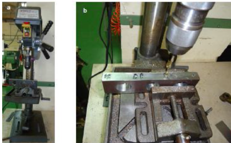
Figura 4.19. Taladro automático OPTIMUM. (a) Vista general. (b) Vista de la broca y la pieza a taladrar.
