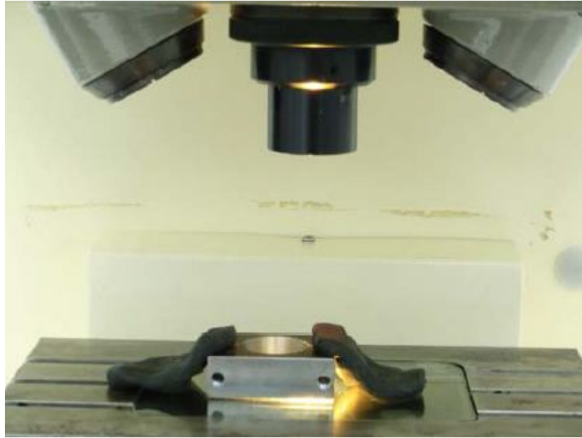
Figura D.6. Medición de redondez con proyector de perfiles.
