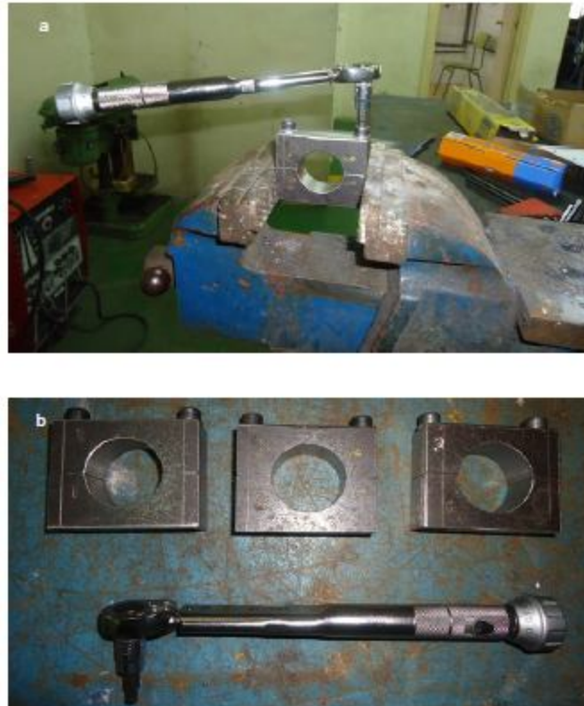
Figura 4.23. Apriete con llave dinamométrica.
