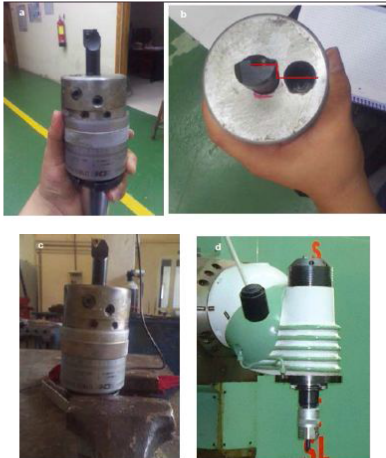
Figura C.7. Proceso de montaje de la herramienta de mandrinar.
