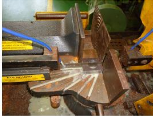
Figura 4.21. Corte de piezas independientes para la fabricación de las chumaceras o componentes bi-piezas.
