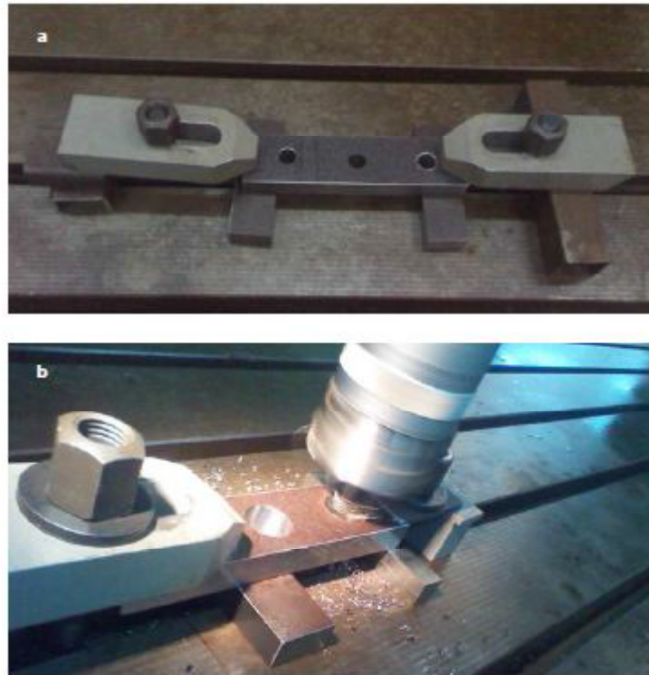
Figura 4.24. (a) Fijación de pieza en la bancada. (b) Mandrinadora trabajando en operaciones de desbaste.
