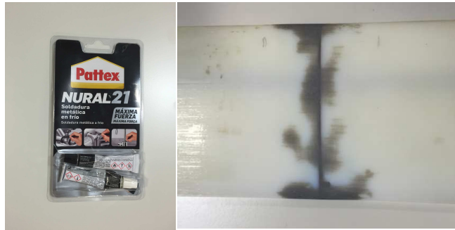
Figura 6.10 Soldadura metálica en frío y resultado de aplicación en el perfil
