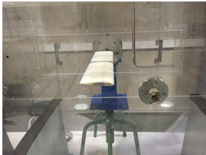
Figura 3.3 Comprobación de la influencia del perfil en la uniformidad y en la velocidad del flujo
