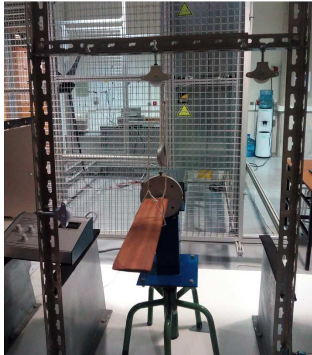
Figura 3.18 Montaje para el ensayo de arrastre
