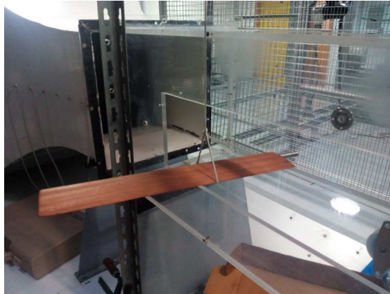
Figura 3.12 Ensayo para determinar el centro de masas del perfil
