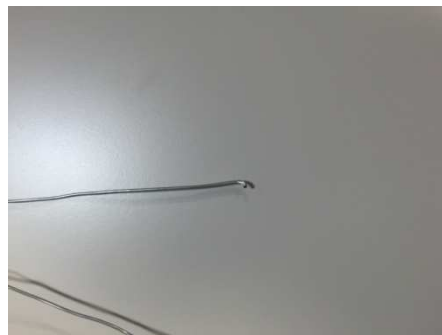
Figura 6.9 Alambre en forma de gancho para limpiar el agujero del perfil en una pieza
