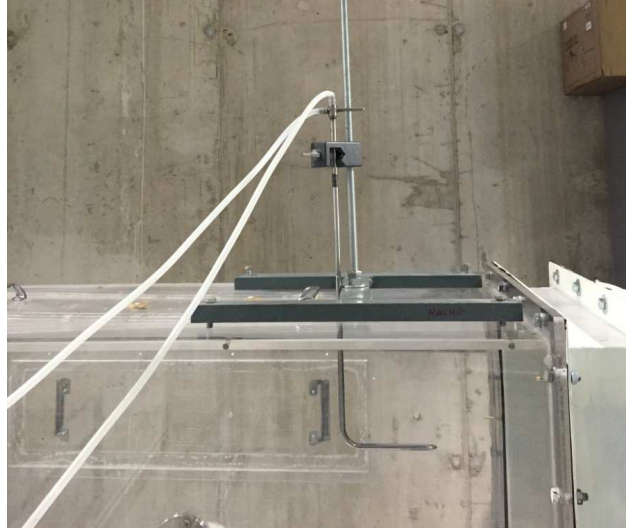
Figura 3.1 Montaje para la determinación de la uniformidad del perfil de velocidades media y para la medida de velocidades
