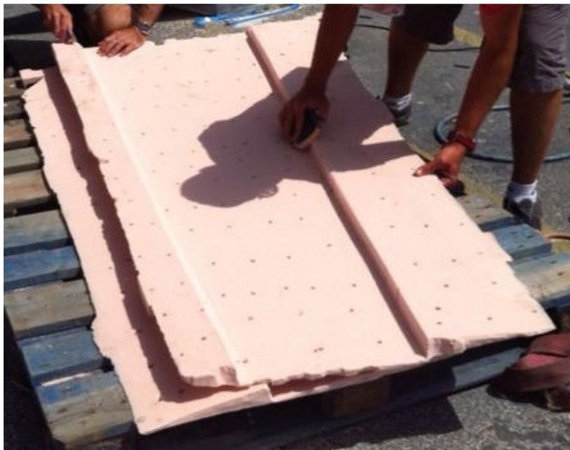
**Ilustración 72. Núcleo de espuma mecanizado de Grand Soleil 37**
