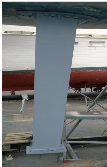
**Ilustración 68. Estructura cajón acabada de Grand Soleil 37**
