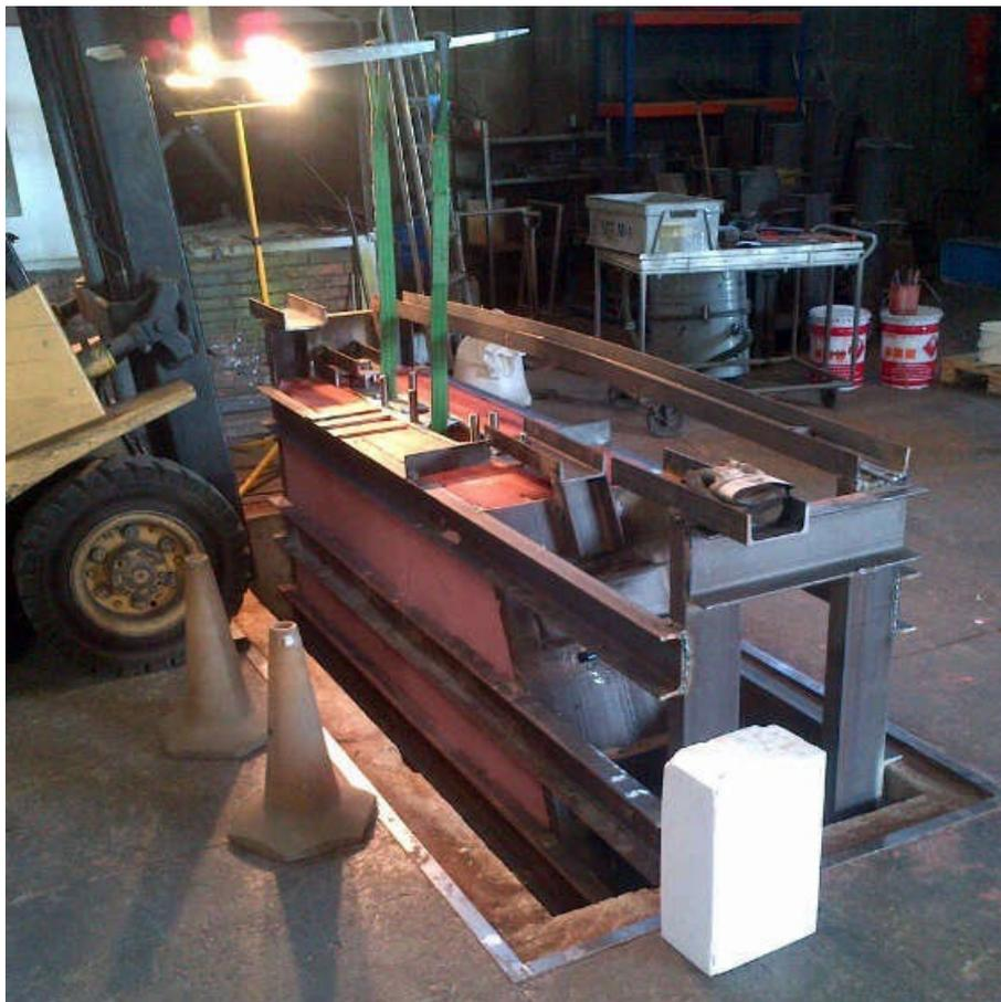
**Ilustración 42. Colocación en foso de molde Wauquiez 45**
