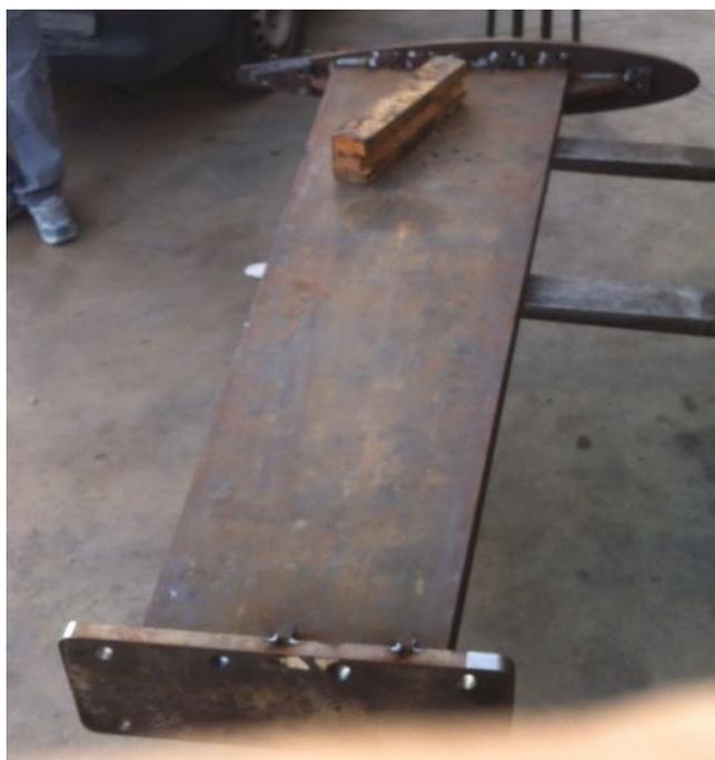
Ilustración 66. Estructura cajón soldada de Grand Soleil 37
