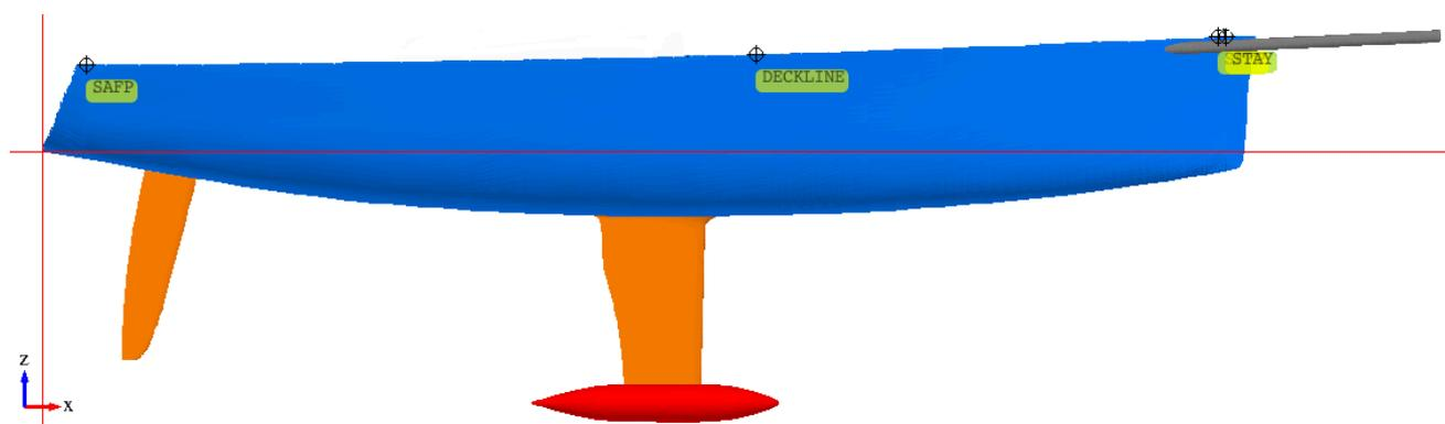
**Ilustración 30. Modelado de casco y apéndices con superficies**
