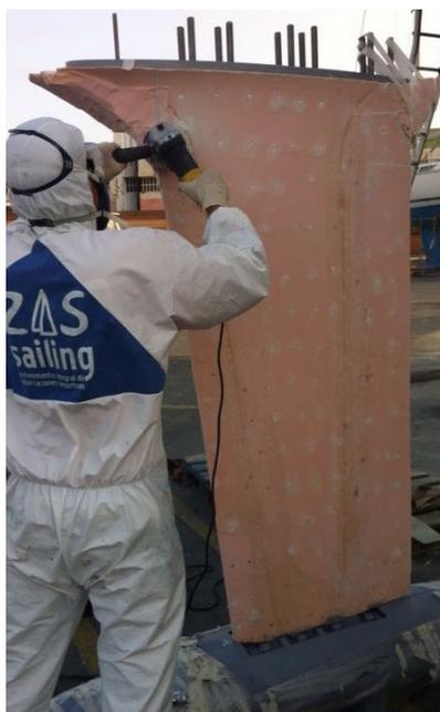
**Ilustración 73. Acabado del núcleo de espuma de Grand Soleil 37**
