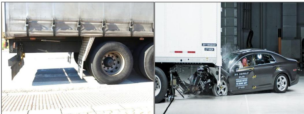
**Figura 7: Dispositivos antiempotramiento. Fuente: Basculantes Ureña y DGT**
