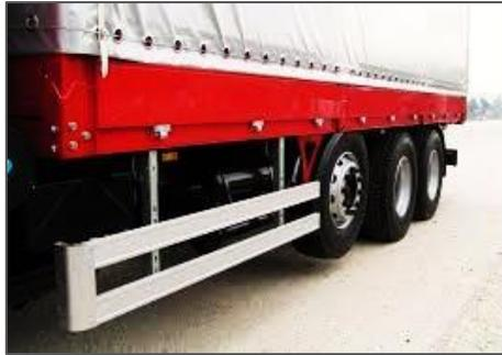
**Figura 8: Protección lateral. Fuente: Basculantes Ureña**
