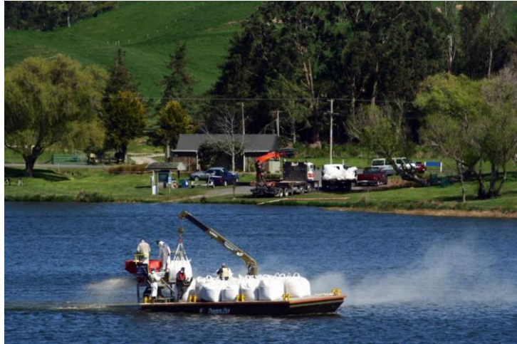
Foto 2: Aplicación de zeolita modificada en el Lago Okaro, Bahía de la Abundancia.
