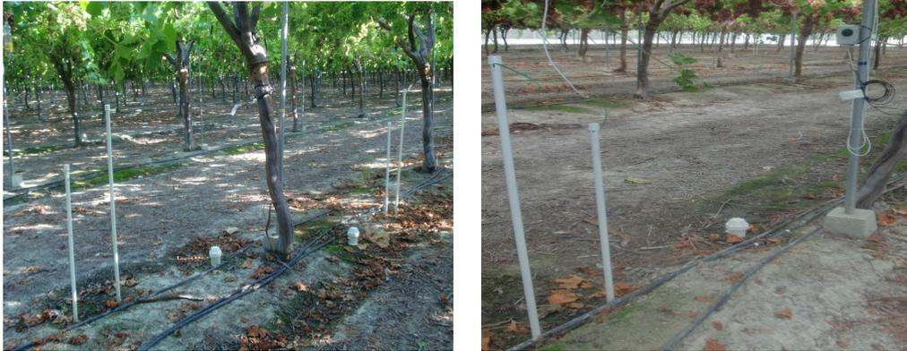
Figura 7. Distribución de sondas FDR en la parcela experimental en los tratamientos DPR, DPRc (imagen 1) y RDC, RDCc (imagen 2).
