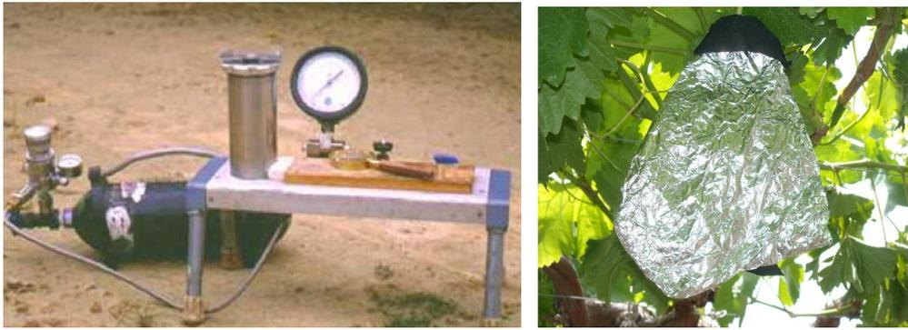
Figura 8. Cámara de presión utilizada y hoja envuelta para la medición de  $\Psi_{t,md}$ .
