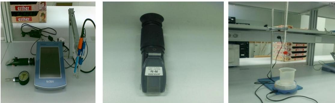
*Figura 11. Medidor de pH y CE, refractómetro manual y equipo de valoración de la AT utilizados.*
