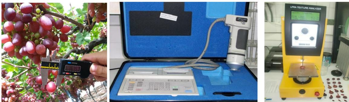
Figura 10. Medición diámetro de la baya. Vista general del colorímetro y medidor de firmeza utilizado en el ensayo.
