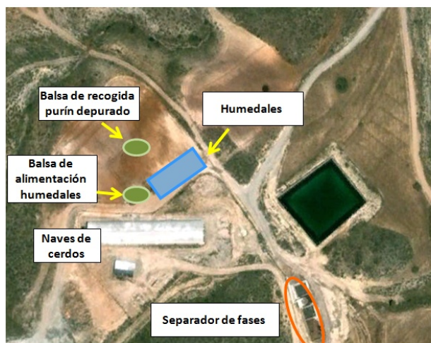
Fig. 1. Situación de los elementos del sistema de depuración de purines en "El Hinojar".
