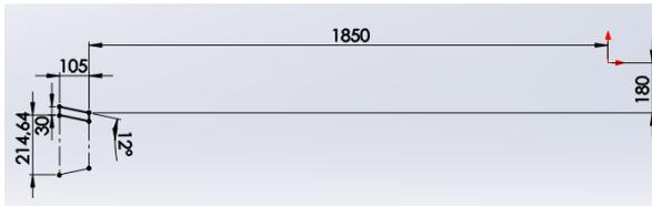
(9) Revolución desde el eje realizado en el croqui 9, 360°; situamos el croqui en el plano 1 de forma que al revolucionar este sea el eje de revolución.
