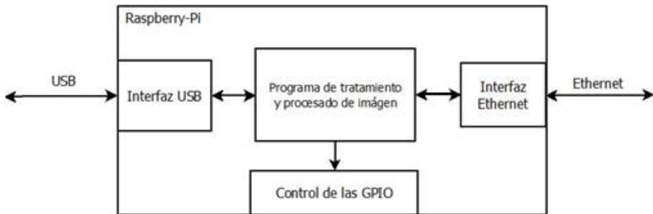
Figura 18: Diagrama del interior de la Raspberry-Pi
