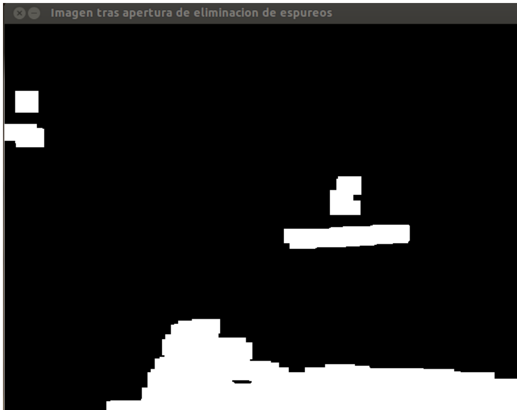
Figura 42: Imagen tras binarización por umbralizado y apertura para eliminación de espurios
