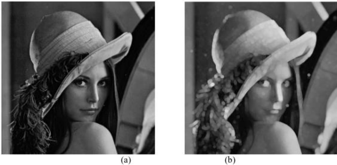
Figura 9: a) Imagen original en nivel de gris; b) Imagen dilatada
