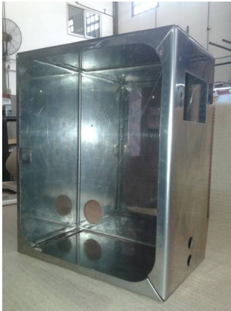
Figura 28: Ejemplo de plegado en acero inoxidable
