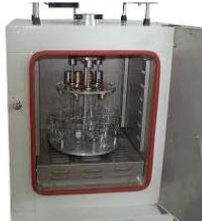
Figura 12: Dip Coater multivessel con control de temperatura y humedad
