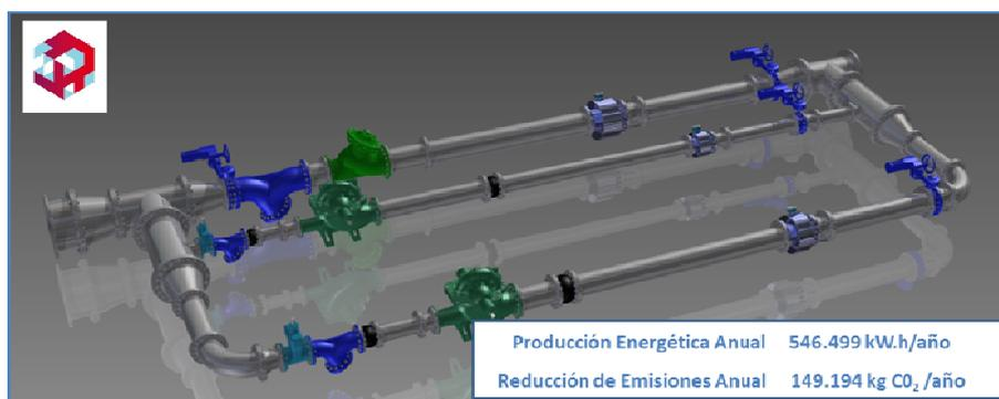
Figura 22. Detalle de una instalación de Bombas Funcionando como Turbinas. Fuente: Aqualogy
