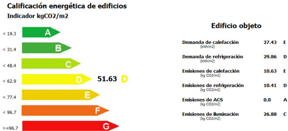
Imagen 42: Calificación energética del edificio Hospital de Marina en CE3X.
