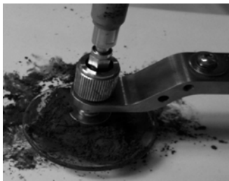
Fig. 1. Medida de polvos metálicos con la sonda coaxial para una muestra FeCu6040
