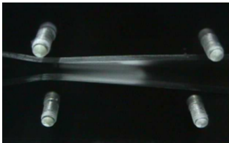
Figura 5.2: Garganta del Venturi con cavitación.[7]
