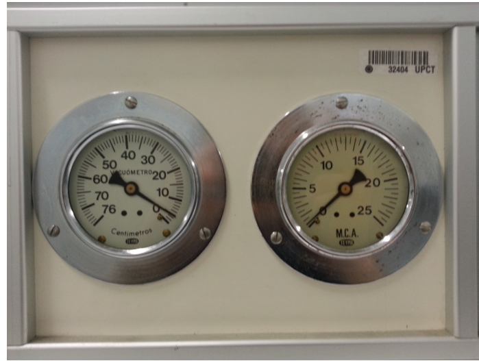
Figura 3.8: Manómetro y vacuómetro de la instalación.
