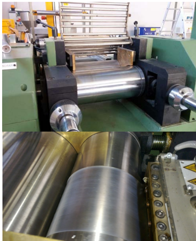
Figura 3.13. Rodillos de enfriamiento (Calandra).
