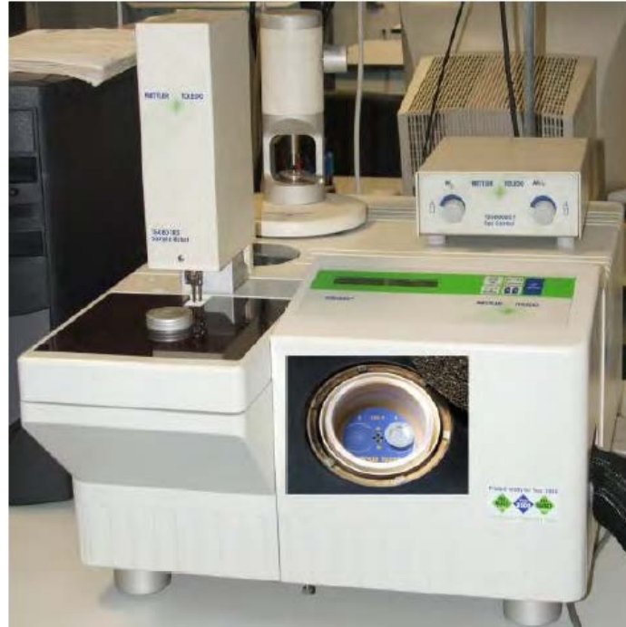
Figura 3.2. Calorímetro diferencial de barrido Mettler-Toledo DSC-822e, con detalle del horno.
