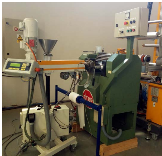
Figura 3.11. Extrusora empleada en el conformado de film.
