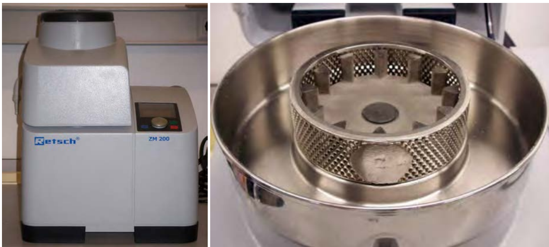
Figura 3.7. Molino ultracentrífugo Retsch ZM 200 con detalle de las cuchillas.
