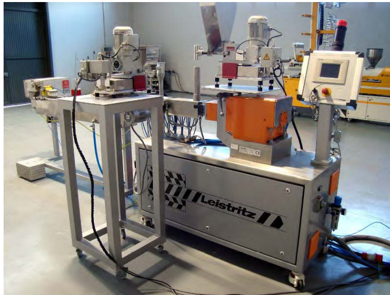
Figura 3.8. Extrusora Leistritz ZSE 18HP.
