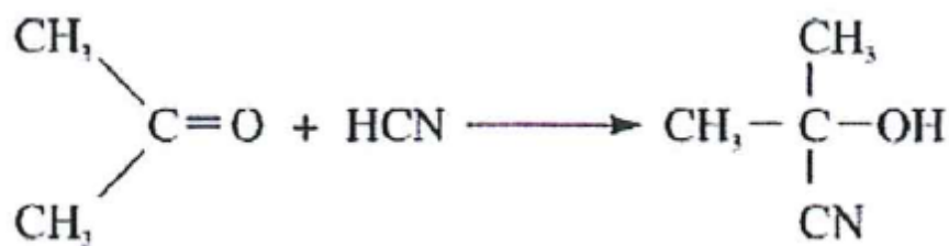
Figura 1.1. Obtención de acetona cianhídrica.
