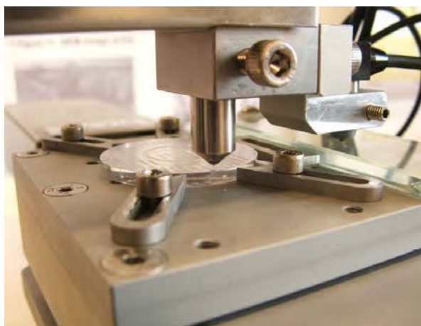
Figura 3.15. Detalle del indentador del equipo de rayado Microtest.
