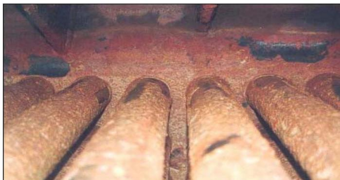
La presencia de incrustaciones en una caldera es especialmente grave debido a su baja conductividad térmica actúa como aislante térmico, provocando problemas de refrigeración de las superficies metálicas y puede llegar a causar daños por sobrecalentamiento.
