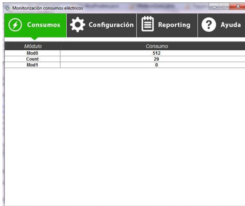
Figura 25. Visualización de valores de registros leídos a través de Modbus en la aplicación cliente.
