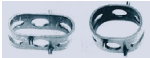
Fig. 3.5 – Espaciadores de columna vertebral de flexinol [23]
