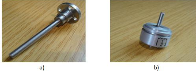
Fig. 4.12 – Eje grande y eje pequeño (potenciómetro) para el sistema de desplazamiento angular
