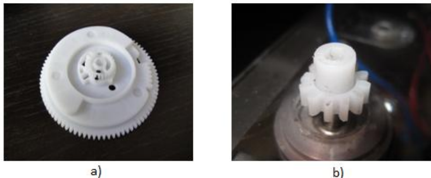
Fig. 4.11 – Engranaje grande (a) y pequeño (b) para el sistema de desplazamiento angular
