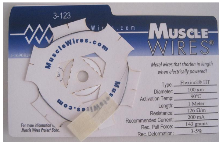
Fig. 4.9 – Cable de Flexinol de 100 \mu\text{m} utilizado en nuestra plataforma de experimentación
