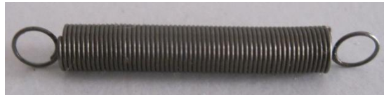
Fig. 4.39 – Muelle usado en el sistema de desplazamiento lineal
