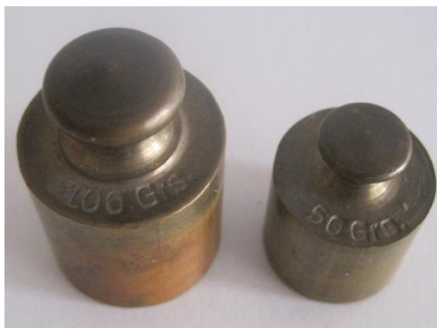
Fig. 4.14 – Pesos usados para obtener la constante K del muelle
