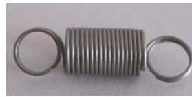
Fig. 4.15 – Muelle usado para el sistema de desplazamiento angular
