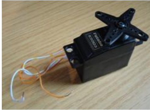
Fig. 4.10 – Motor1 DC: servo motor Futaba S3003 utilizado en nuestra plataforma
