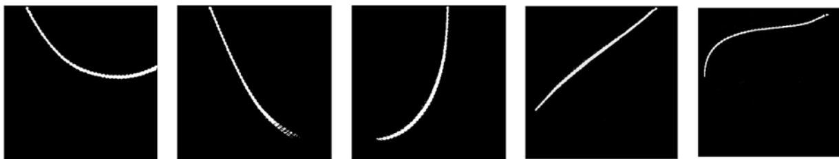
Figura 5.11: Imágenes del experimento realizado por Lazzari et al, (2001) con la evolución del cable en vibración libre sometido a cargas gravitatorias.
