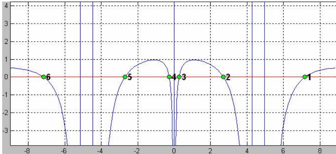
Figura 6.19-Soluciones de los Armónicos Espaciales en Estructura Periódica Cerrada ( f=42\text{GHz} ).
