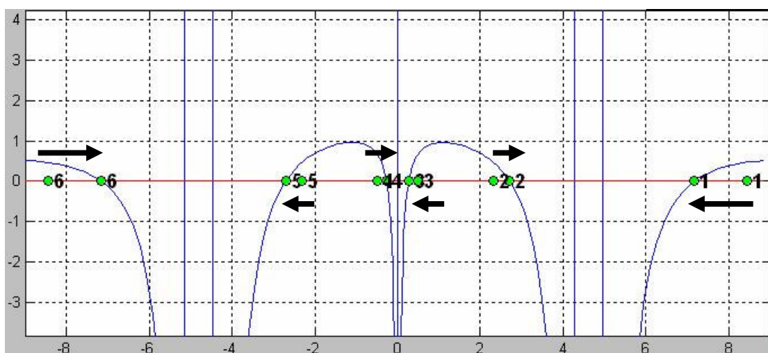
Figura 6.20- Variación de las Soluciones de los Armónicos Espaciales al Variar la Frecuencia de 40GHz a 42GHz.
